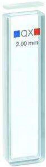
Макроячейка типа 100-QX со стеклянной крышкой для измерений поглощения, материал окна Кварцевое стекло расширенного диапазона (200 нм - 3500 нм), объем 700 мкл, длина пути 2 мм, внешние размеры 45 x 12,5 x 4,5 мм, внутренняя ширина 9,5 мм, толщина основания 1,5 мм
